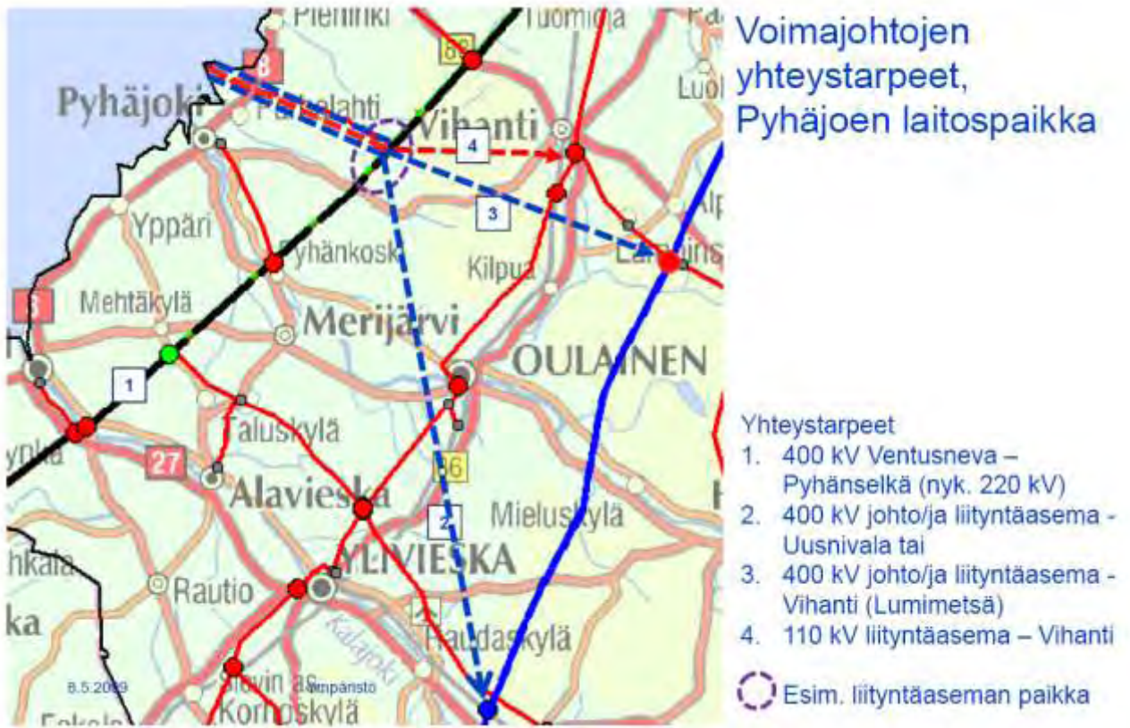
Periaatekaavio Hanhikiven ydinvoimalan liittämistä kantaverkkoon. Yhteydet 2 ja 3 ovat vaihtoehtoisia. (Kuva Fingrid Oy 11.5.2009)
